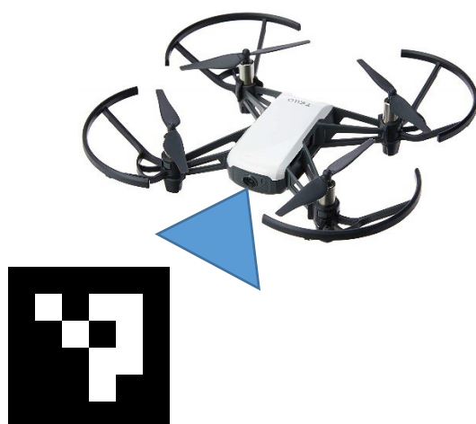
Slika 2: Ryze Tech Tello dron in ArUco značka
